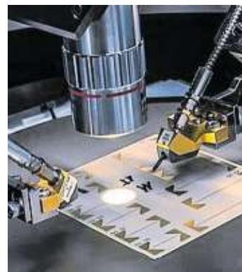
Im Labor unterzieht man Chips elektrischen Tests
